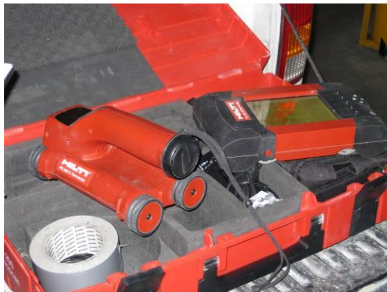
Figura 4.6 Equipo utilizado para el escaneo del acero de refuerzo
