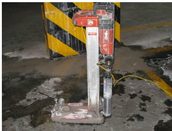
Figura 4.2 Equipo utilizado para la extracción de los corazones de concreto
